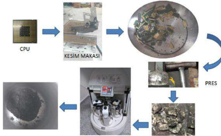
Şekil 2. CPU için numune hazırlama süreci
