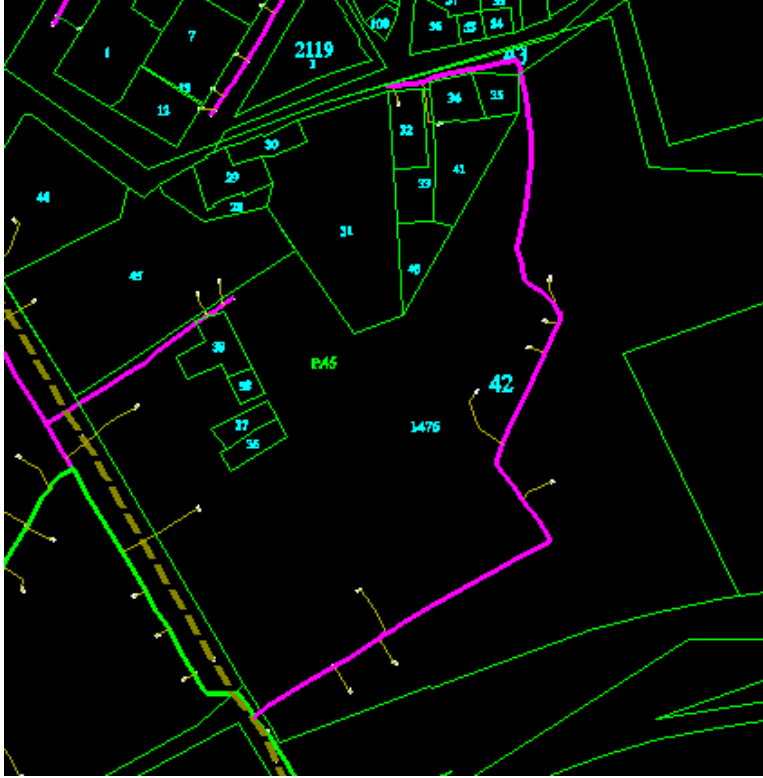
Şekil 7. Parsel içerisindeki doğal gaz hattı
