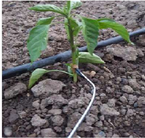
Şekil 2.2. Bitki Nem Sensörünün Bitki Gövdesine Yerleştirilmesi
