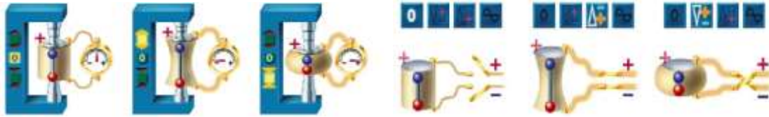
Şekil 1. Doğrudan ve ters piezoelektrik etki [6]
