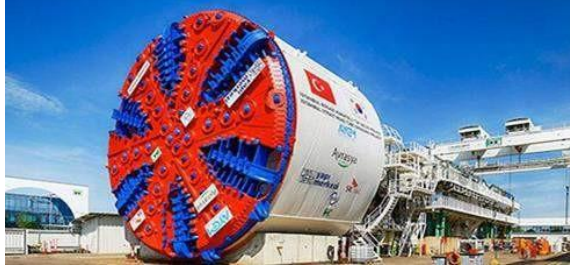
Resim 1. Karışık Zemin Kazısına Uygun Tam Cepheli Tünel Açma Makinesi [5]
